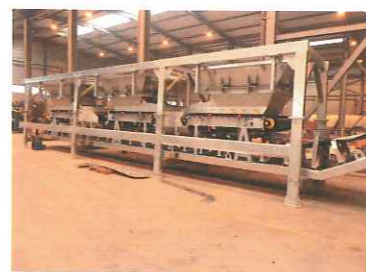
Trémies de réception des agrégats. Et l'on découvre le système de pesée en continu : 20 fois par seconde exactement.
