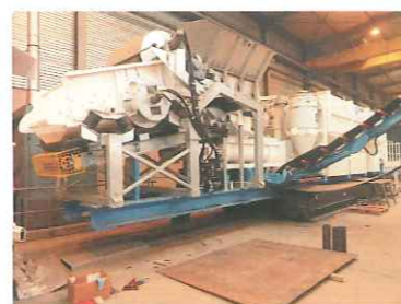
Machine à chauler entièrement autonome par son moteur thermique et son réservoir de 2,5 m 3 de gazole, poids de 44 t et capacité de 200 t/h. Groupe électrogène en sus ! Et elle devient station-service de gazole pour les petits engins du chantier.
