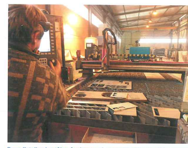
Dans l'atelier, les tôles épaisses qui composent les machines sont découpées au plasma par une machine robotisée, sur une table longue de 12 m.
