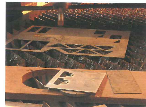
Les découpes sont nettes et précises. La CAO optimise les chutes.
