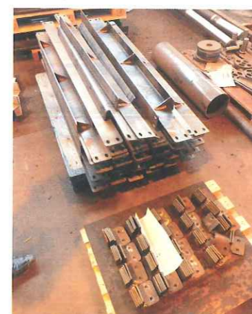
La fabrication d'une machine comprend différentes pièces découpées, pliées, percées et soudées.
