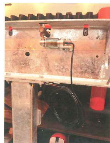
Trémies de réception des agrégats. Et l'on découvre le système de pesée en continu : 20 fois par seconde exactement.
